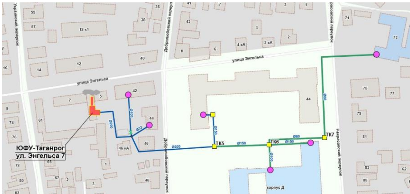
Рисунок 21 - Симуляция аварийной ситуации на тепловой сценарий
